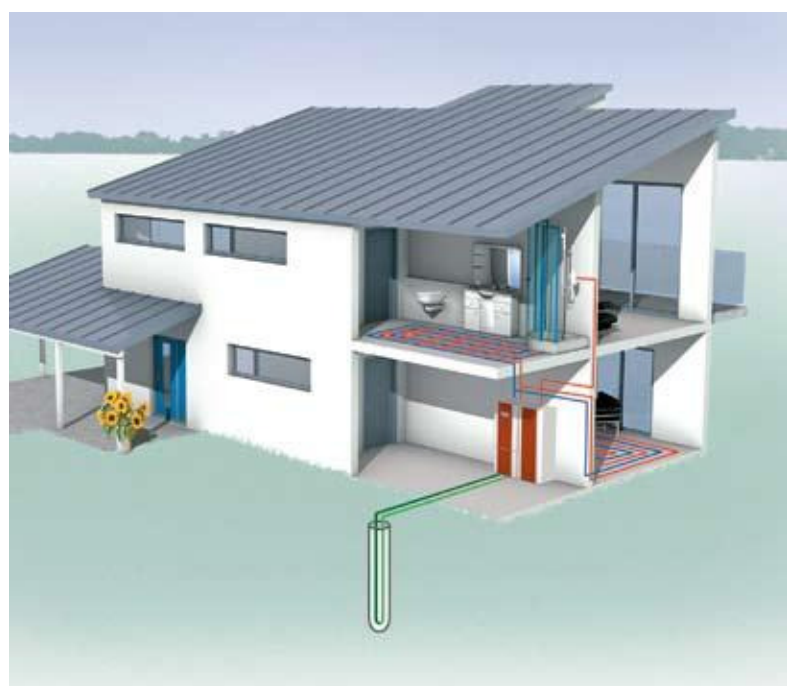
Pompa ciepła solanka/woda z sondą gruntową
