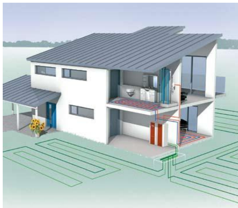
Pompa ciepła solanka/woda z kolektorem gruntowym
